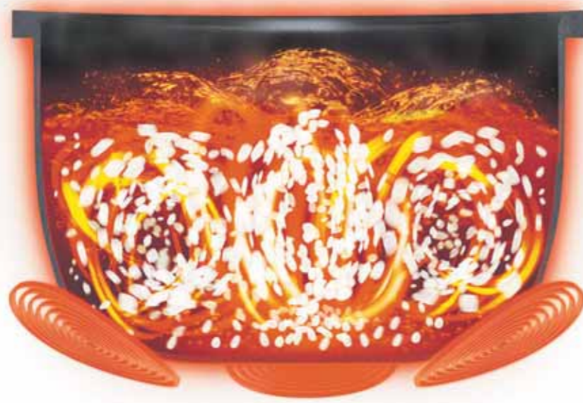
激しく複雑な対流を起こす、新たな底IHヒーターの構造
