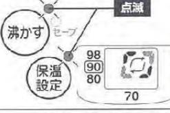
2つのランプが同時点滅し、液晶表示が回転する       | 「沸かず」キーを3秒以上押しませんでしたか？クエン酸洗浄中です。               | クエン酸洗浄を取り消す場合、プラグをいったん抜き、5秒以上たってからもう一度接続してください。→P.15 |
