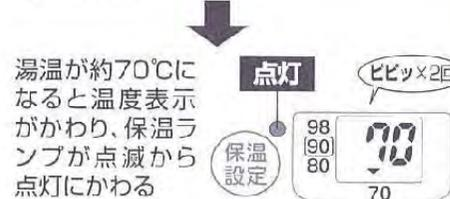
湯温が約70℃になると温度表示が変わり、保温ランプが点滅から点灯にかわる
