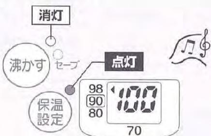
湯沸かしが完了するとメロディーが鳴り、湯沸かしランプが消灯、保温ランプが点灯
