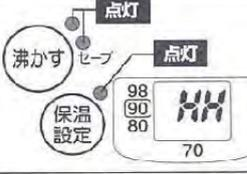
ブザーが鳴り、ランプが点灯し、液晶が図のような表示をする | 水は少ないですか？プラグ接続直後に熱湯を入れませんでしたか？空だき防止機能がはたっています。 | プラグを抜き、内容器が十分冷めてから水を入れ、再びプラグを接続してください。→P.9           |
