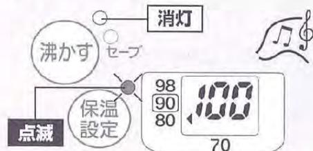
湯沸かしが完了するとメロディーが鳴り、湯沸かしランプが消灯、保温ランプが点滅
