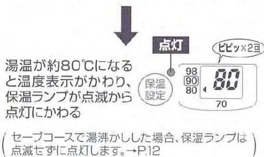
湯温が約80℃になると温度表示が変わり、保温ランプが点滅から点灯にかわる
