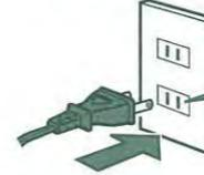
●定格15A以上のコンセントを単独で使用してください。（他の器具と併用すると分岐コンセント部が異常発熱して発火する恐れ）
