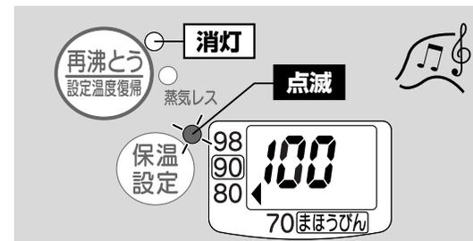
湯わかしが終わるとメロディーが鳴り、沸とうランプが消灯、保温ランプが点滅(保温中に設定した場合、80保温設定の2秒後に点滅にかわります。)
