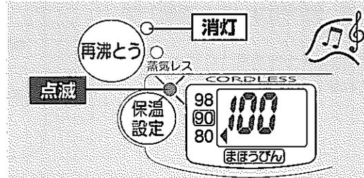
湯わかしが終わるとメロディーが鳴り、沸とうランプが消灯、保温ランプが点滅(保温中に設定した場合、80保温設定の2秒後に点滅にかわります。)
