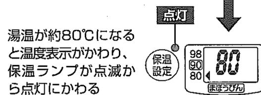
湯温が約80℃になると温度表示が変わり、保温ランプが点滅から点灯にかわる
