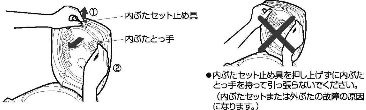
**つけ方** 内ぶたセットのツメ(2ヵ所)を外ぶたのツメ差し込み部に合わせて、内ぶたセット止め具がカチッと音がするまで押し込む
