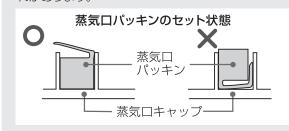
②蒸気ロキャップの受け部(2ヵ所)に蒸気ロケースの 軸部(2ヵ所)を差し込み、指かかり部が「カチッ」と いうまで確実に閉める
