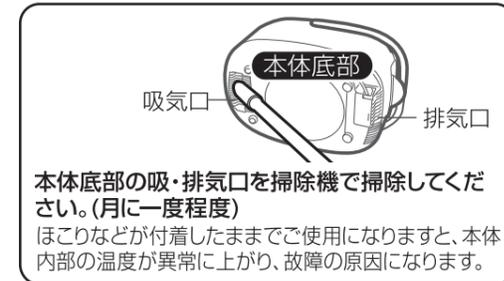
本体底部の吸・排気口を掃除機で掃除してください。(月に一度程度)
