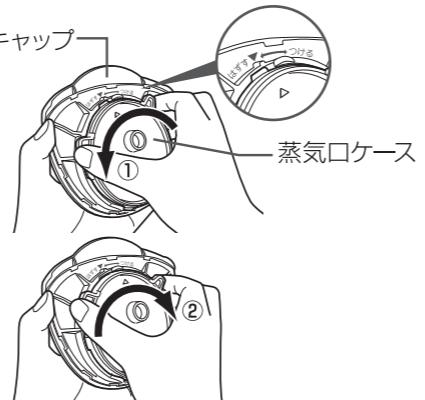
**つけ方** 蒸気口キャップの△マークと蒸気口ケースの△マークを合わせ「つける」表示方向に止まるまで回して確実につける(②)
