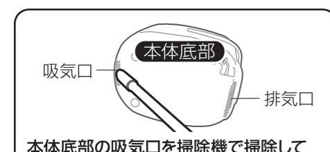
本体底部の吸気口を掃除機で掃除してください。(月に一度程度)
