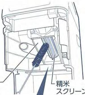
精米スクリーン上部の米ぬかを取り除くときは、精米スクリーンに沿わせながら奥に入れてください。
