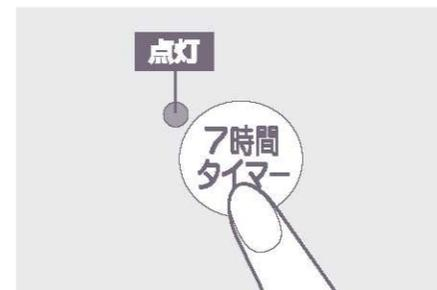
●タイマーランプと保温ランプが約2秒間同時に点灯し、保温ランプが消灯します。
