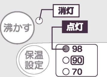
湯沸かしが完了すると湯沸かしランプが消灯、保温ランプが点灯
