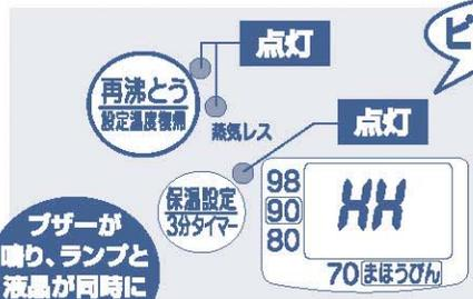
ブザーが鳴り、ランプと液晶が同時に点灯する
