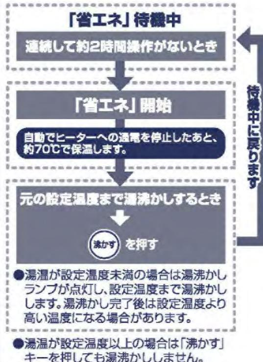
自動でヒーターへの通電を停止したあと、約70℃で保温し、消費電力量を節約できます。
