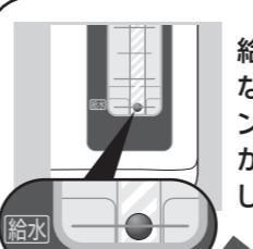
給水表示(約500mL)以下になるとブザーが鳴り、給水ランプと、液晶の「給水」マークが点灯し、給水のお知らせをします。
