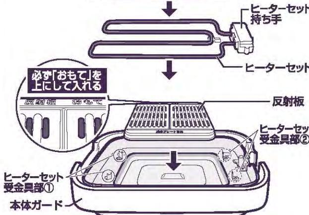
●ヒーターセットを取りつけるときは、ヒーターセット受金具部①に先にヒーターセットを載せ、次にヒーターセット受金具部②にヒーターセット持ち手側を取りつけてください。
