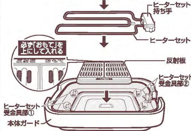
● ヒーターセットを取りつけるときは、ヒーターセット受金具部①に先にヒーターセットを載せ、次にヒーターセット受金具部②にヒーターセット持ち手側を取りつけてください。
