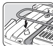
●ヒーターセット受金具部Ⓐ・Ⓑ(4力所)に確実にヒーター部が載っていることを確認してください。
