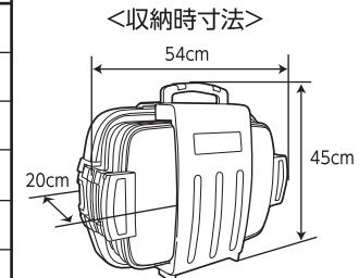
●外形寸法は平面プレートを取りつけた状態で、ふたをしたときの寸法です。
