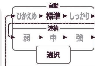
**自動** 設定した運転モードのヒーターON時間で加湿します。
