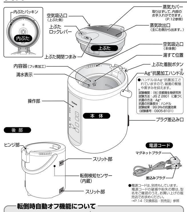
この製品には、「転倒時自動オフ機能」がついています。使用中に製品を傾けたり、万一製品が転倒した場合に、「転倒時自動オフ機能」が作動し、自動的にヒーターへの通電を止めます。(運転ランプがすべて点灯し、お知らせします。)
