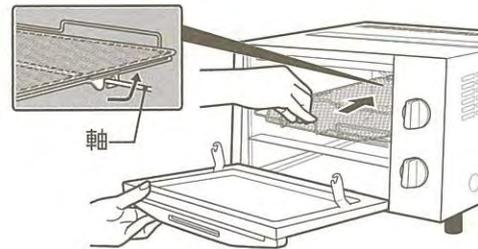
**お願い** 焼き網をはずすと、とびらが全開しますので、勢いよく開閉しないでください。また、とびらに強い力をかけないでください。(変形・故障の原因)
