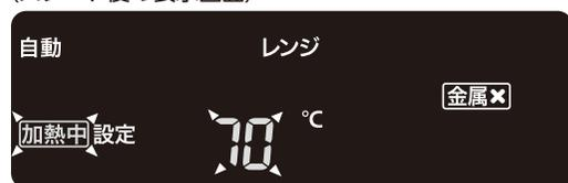
「加熱中」と設定温度が点滅し、調理を開始します。
