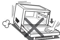
変形し、電波漏れの原因になります。また、本体が転倒・落下してけがの恐れがあります。
