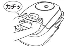
炊飯の途中で外ふたを開ける場合は、表示部の「圧力」の表示が消えているのを確認してから、外ふたを開ける
