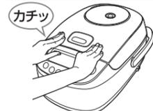
炊飯の途中で外ぶたを開ける場合は、表示部の圧力の表示が消えているのを確認してから、外ぶたを開ける
