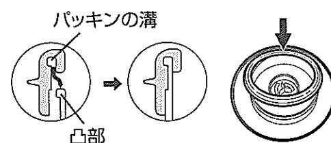
②順次外周をパッキンの上から指で押し、パッキンの溝を蒸気口ケースの凸部に確実に差し込む
