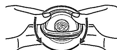
4 パッキンを取りつけた蒸気口ケースは、傾きがないように、蒸気口にきっちりと押し込む
