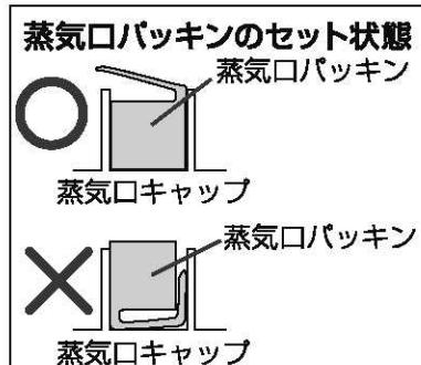
2. 蒸気口キャップの受け部(2カ所)に蒸気口ケースの軸部(2カ所)を差し込み、指かかり部がカチッというまで確実に閉める
