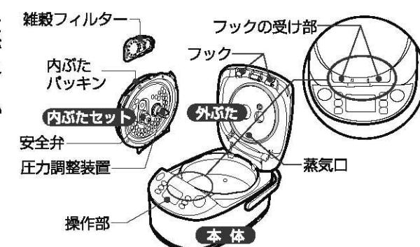
炊飯の途中に外ぶたを開ける場合は、操作部の圧力表示が消えているのを確認してから、外ぶたを開ける
