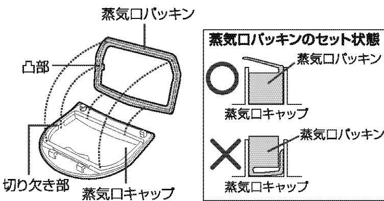
2. 蒸気口キャップの受け部(2カ所)に蒸気口ケースの軸部(2カ所)を差し込み、指かかり部がカチッというまで確実に閉める
