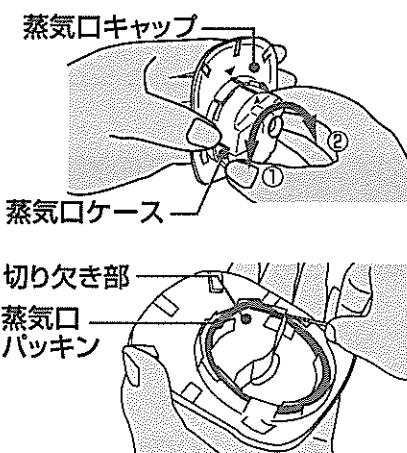
蒸気口セットの外側、内側は水で流し洗いする
