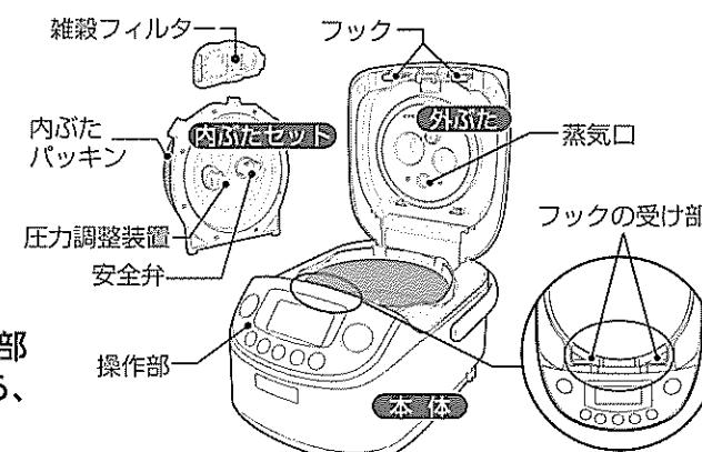
炊飯の途中に外ぶたを開ける場合は、操作部の圧力表示が消えているのを確認してから、外ぶたを開ける
