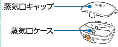
蒸気口セット取り付け部
