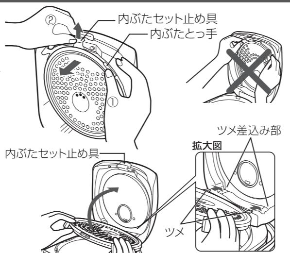
**つけ方** 内ぶたセットのツメ(2カ所)を外ぶたのツメ差込み部に合わせて、内ぶたセット止め具が「カチッ」と音がするまで押し込む
