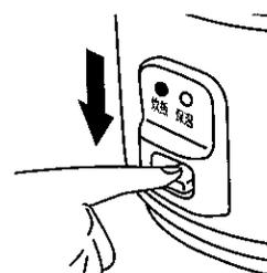
炊飯スイッチを押し下げ、炊飯ランプを点灯させる。
