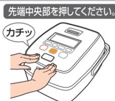
炊飯の途中で外ぶたを開ける場合は、表示部の「圧力」の表示が消えているのを確認してから、外ぶたを開ける
