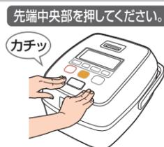
炊飯の途中で外ぶたを開ける場合は、表示部の「圧力」の表示が消えているのを確認してから、外ぶたを開ける
