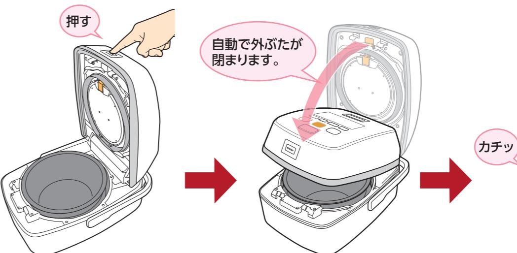
●スマートクローズ作動中にスマートクローズスイッチをもう一度押すと外ぶたが開きます。
