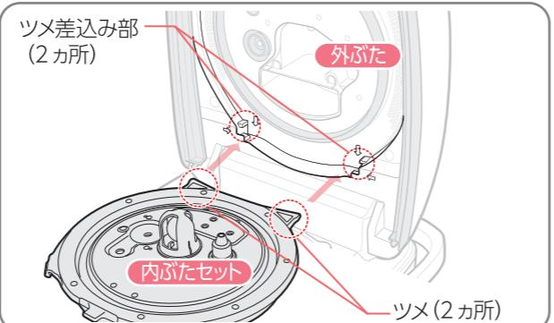
①内ぶたセットのツメ(2カ所)を外ぶたのツメ差込み部の矢印に合わせて差し込む
