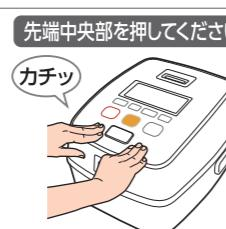
炊飯の途中に外ぶたを開ける場合は、表示部の「圧力」の表示が消えているのを確認してから、外ぶたを開ける
