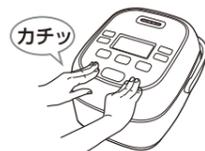
炊飯・クリーニングの途中に外ぶたを開ける場合は、表示部の「圧力」の表示が消えていることを確認してから外ぶたを開ける
