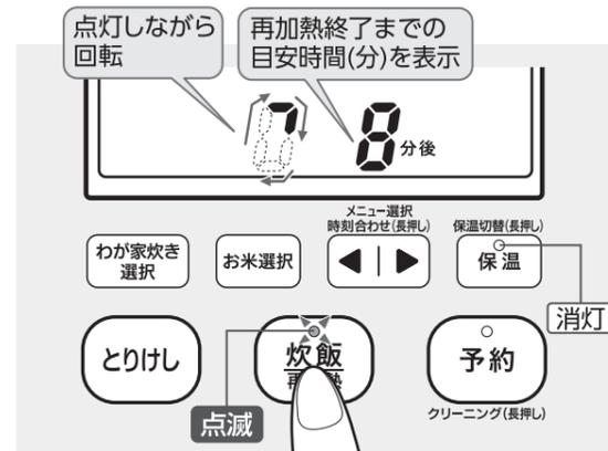
**点灯** 保温ランプが点灯していないときに「炊飯/再加熱」キーを押すと炊飯を開始します。
