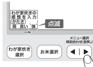
**3** **わが家炊き** を押し、ブザー(「ピー」×2回)が鳴り、「かたさ」の感想の入力が決定します。続いて **粘り** が点灯し、「良い」が点滅します。
