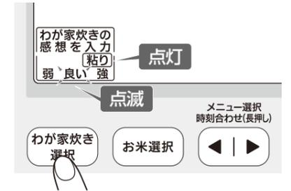
**4** ◀ を押して「弱」を選択します。「弱」が点滅します。
