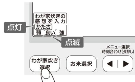
**2** ▶ を押して「強」を選択します。「強」が点滅します。
