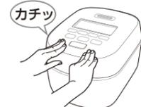
炊飯・クリーニングの途中に外ぶたを開ける場合は、表示部の「圧力」の表示が消えていることを確認してから外ぶたを開ける
