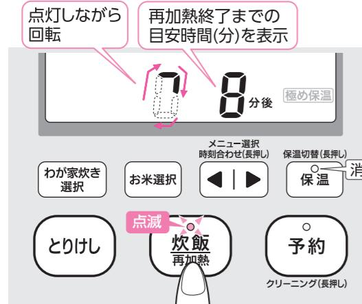
保温ランプが点灯していないときに「炊飯/再加熱」キーを押すと炊飯を開始します。
