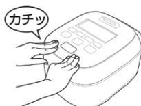
炊飯・クリーニングの途中で外ぶたを開ける場合は、表示部の「圧力」の表示が消えていることを確認してから外ぶたを開ける
