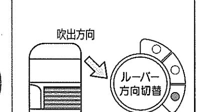
風の吹出方向をお好みの角度に固定したい場合は、一度、「オートルーバー切/入」キーを押して作動させてから、オースイングルーバーがお好みの角度になったところで、再度「オートルーバー切/入」キーを押して停止させてください。
