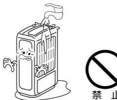
■移動するときは必ず運転を停止し、内部のタンクの水を切る
