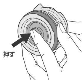
②スプリング押さえをしっかりとつかみ、押し込みながら矢印の方向に90度に回し、スプリング押さえとスプリングをはずします。
